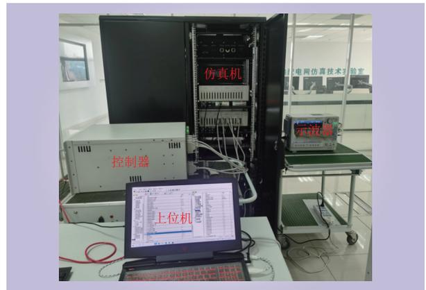
图 6 双馈风机控制器半实物测试平台
